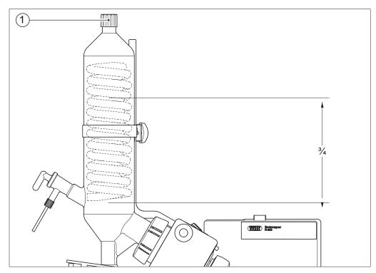
Fig. 41: Cooling condenser
